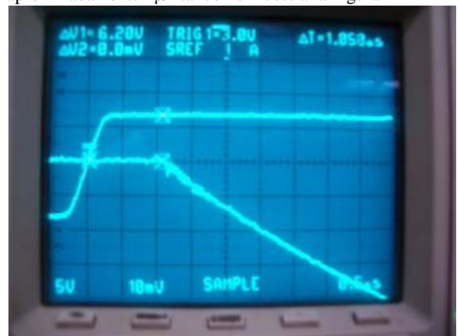
Figura 14 : Comando y corriente a la salida de la rama de prueba
