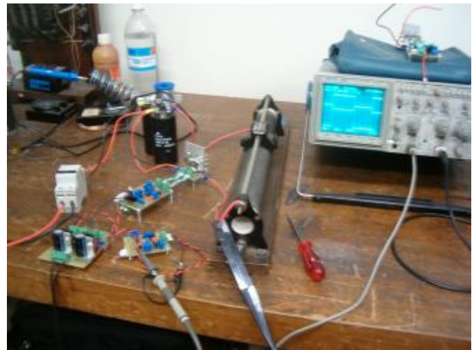
Figura 13 : Banco de ensayo para probar el diseño de la rama y su comando
